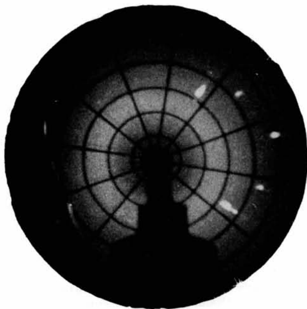
Fig. 3. Polarkoordinatennetz als Bezugssystem, an der Vorderfront des Röntgenbildverstärkers befestigt. Araldit als Streukörper. Gleichzeitige Belichtung der NaCl-Reflexe (15 sec.). Schattenwurf des Primärstrahlenfängers und des Präparat-trägers.
